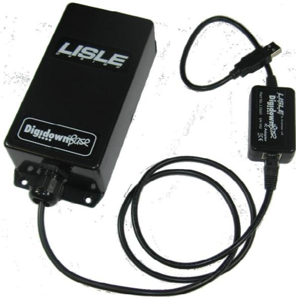
Diese Box ermöglicht den automatischen Download sobald das Fahrzeug auf den Depot Hof ankommt.
